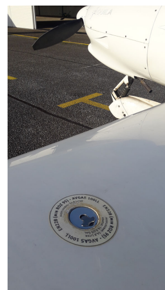
Fig.1 – Sens de la languette des bouchons de carburant
