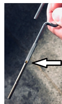
Fig.4 - Niveau bas sur la jauge d'huile.
